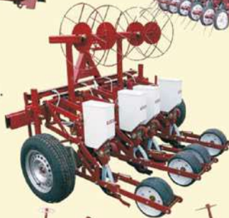
«Клен-1,8» с укладчиками капельной трубки
