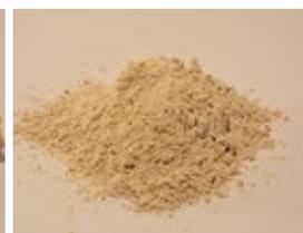
Рис.16. Измельченный шрот из чистого подсолнечного ядра. Мелкодисперсный помол.
