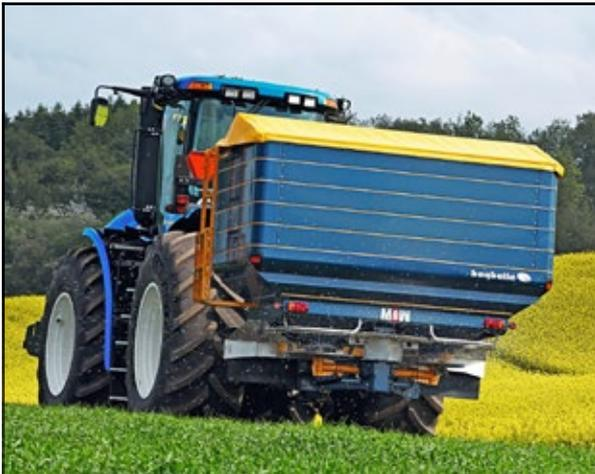
Среди главных преимуществ данной техники выделяют: четырехразовое перекрытие внесения удобрений на посевах или полях; качество покрытия рабочих поверхностей техники; гарантия отдельных узлов до 30 лет; хорошо регулируемые узлы машин по высоте; встроенные решета, которые улучшают качество разбрасывания; наличие специальных конусов и лопаток, которые позволяют хорошо распределять массу удобрений и не давать ей слеживаться; объем бункера до 2050 л.
