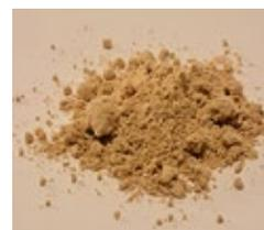
Рис.14. Измельченный жмых после прямого прессования чистого подсолнечного ядрышка.
