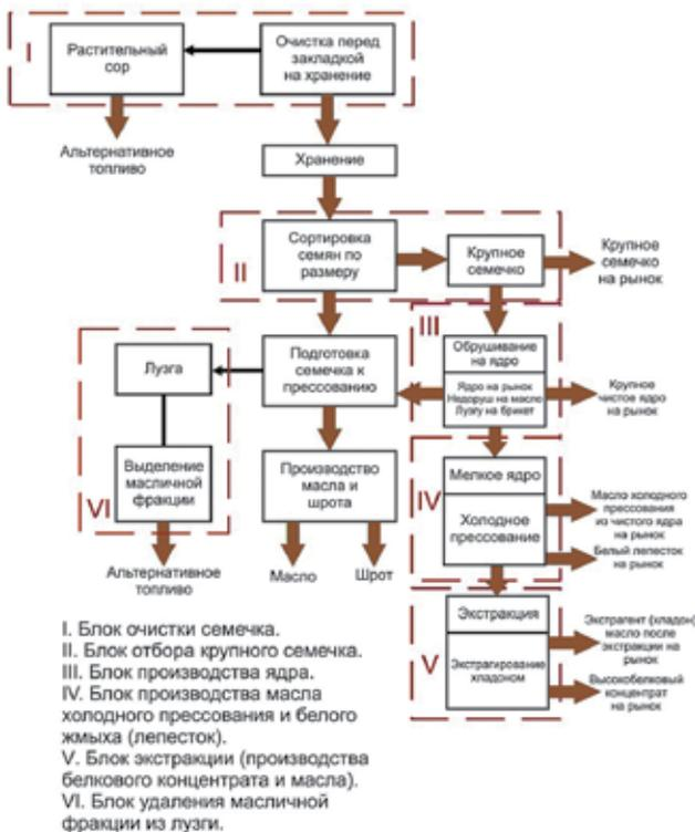
Рис.11. Блок-схема углубленной переработки семян подсолнечника.
